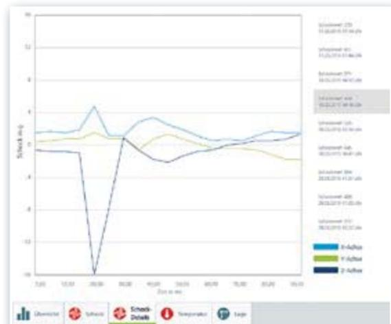
Der Verlauf eines Schocks ist pro Achse im Detail nachvollziehbar.
